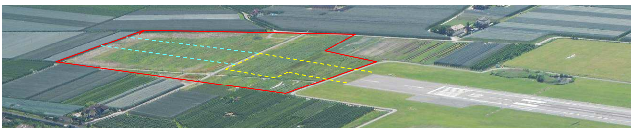
Figura 3: area di espansione dell'aeroporto (rosso), perimetro della pista prevista dal progetto definitivo-esecutivo approvato definitivamente dal consiglio di stato nel giugno 2015 (tratteggio giallo), allungamento pista e asfaltatura resa (tratteggio azzurro) previsto dal Masterplan del 2012
